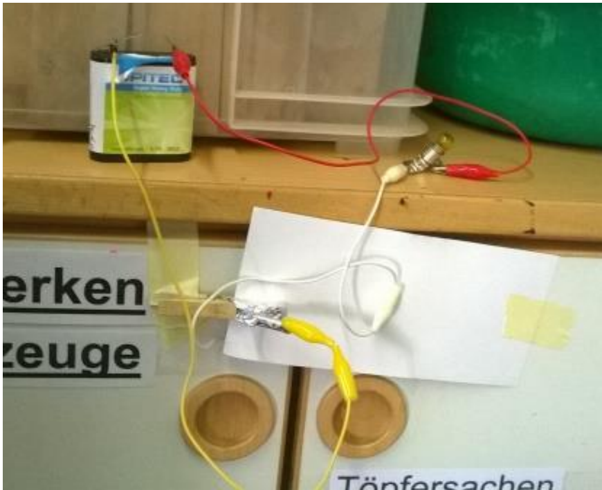
Alarmanlage, die leuchtet, wenn sich der Schrank öffnet. Trick: Papier zieht sich aus Wäscheklammerschalter
